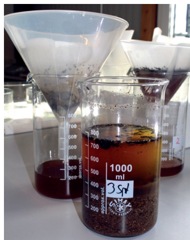
Trennung einer Sedimentprobe in Natriumpolywolframatlösung.
