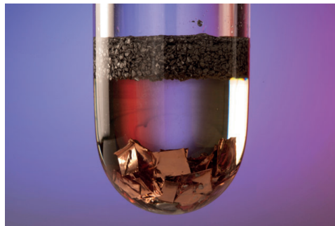
Trennung von Aluminium- und Kupferpartikeln durch Sink-Schwimmanalyse. Foto: Tungsten Compounds
